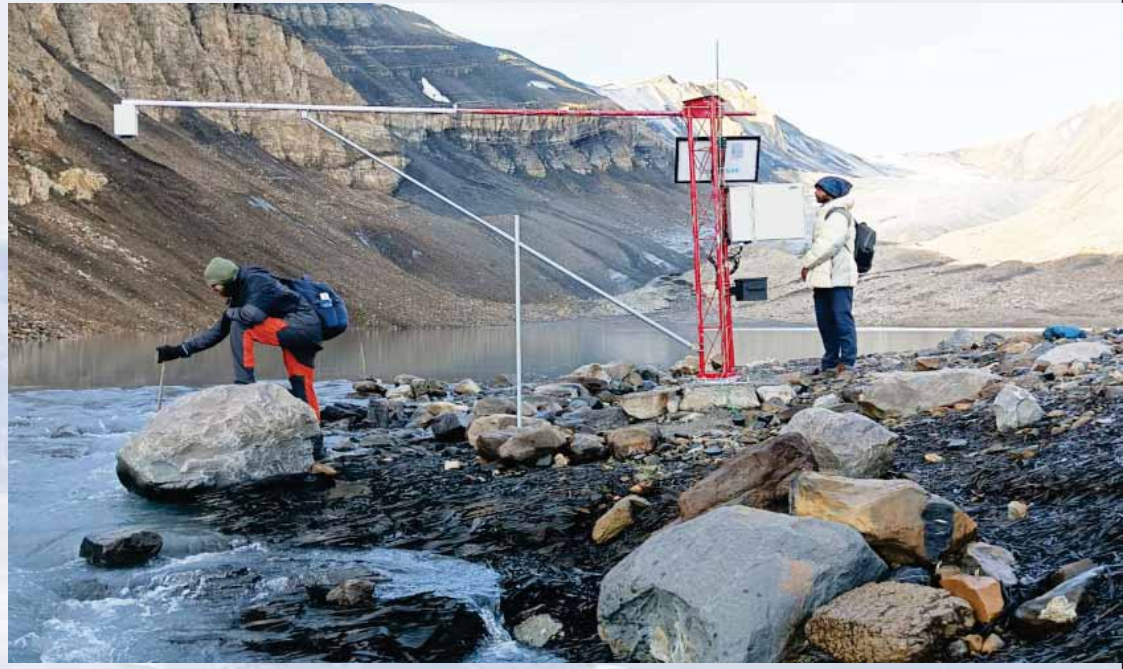
द्र बेसिन में स्थित चंद्रन ग्लेशियर पर जलस्तर रिकॉर्डर से डेटा प्राप्त करना / Data retrieving from Water Level Recorders at Chandran Glacier, Chandra Basin
