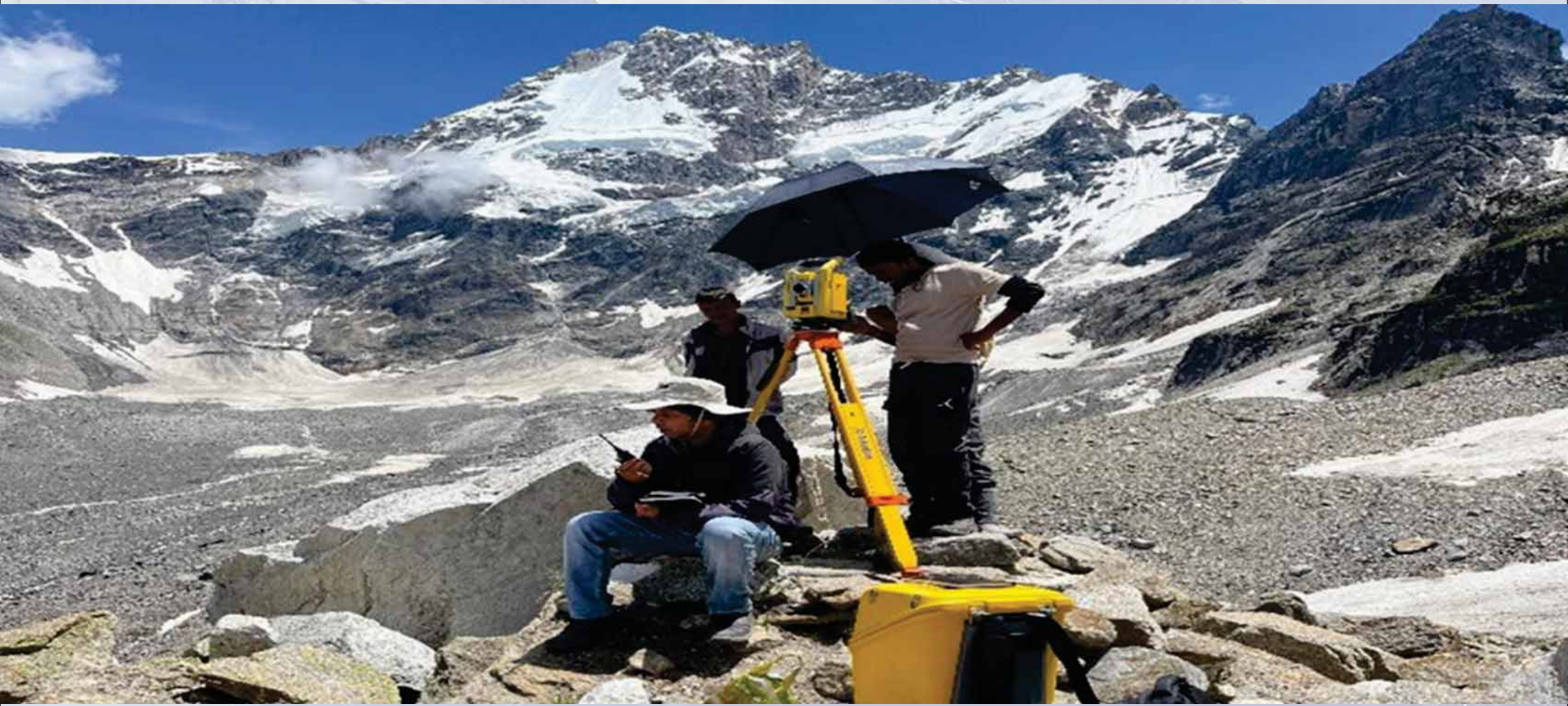
उत्तराखंड के पिथौरागढ़ जिले के दरमा घाटी में प्युंगरु हिमनदी झील का सर्वेक्षण टोटल स्टेशन उपकरण का उपयोग करके किया गया / Surveying of Pyungru proglacial lake using total station instrument, Darma valley, Pithoragarh district of Uttarakhand.
